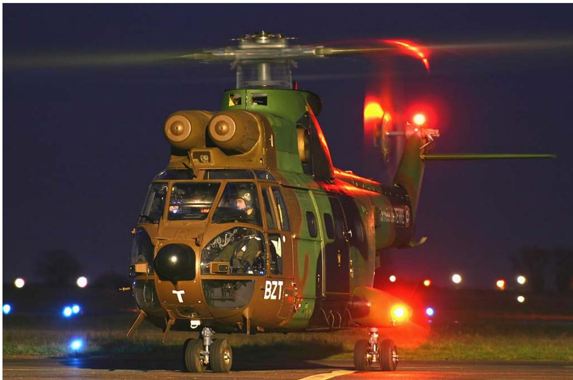
*Le Puma ALAT équipé du détecteur d'alerte radar FRUIT.*
